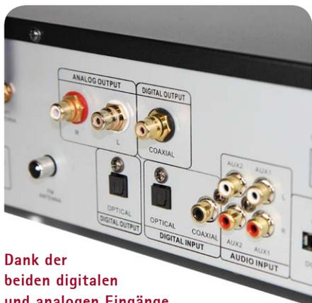
Dank der beiden digitalen und analogen Eingänge können weitere Audio-Zuspieler problemlos an dem X-Uni angeschlossen werden. So profitieren auch sie von der erstklassigen Klangqualität des eingebauten Digitalaudiowandlers
